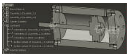
Fig. 9. Ansamblul motor hidraulic liniar reprezentat tridimensional (secțiune)
