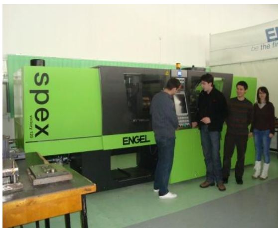
Figura 18. Mașină de injecție în matriță ENGEL-VICTORY-SPEX 50 (sala CF014bis) (© 2011-TCM-LTPC)
