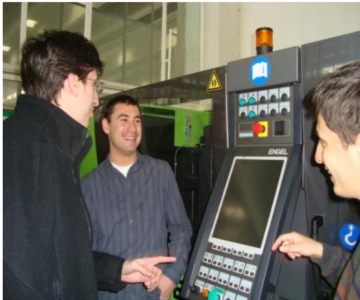
Figura 19. Panou de comandă la mașina de injecție ENGEL-VICTORY-SPEX 50 (sala CF014bis) © 2011-TCM-LTPC)
